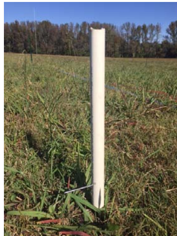
PVC over Rebar Rod
