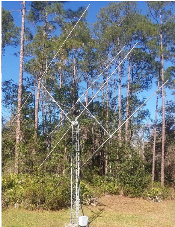
N9HF 4xFO16 222 MHz EME Array
